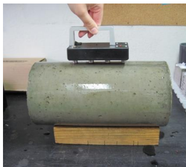
Figura 11. Izquierda: método directo, centro: método de las 4 puntas y derecha: Resistivímetro portátil
