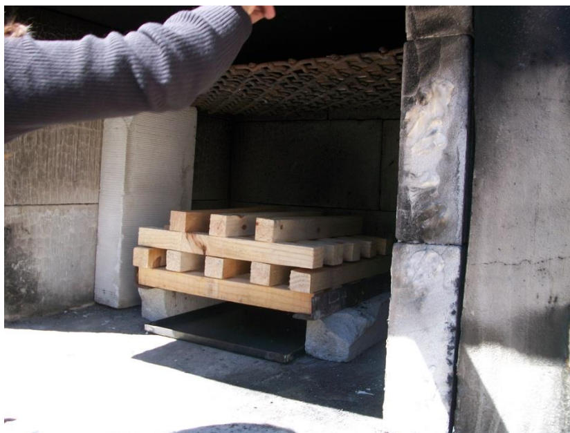
Figura 3. Disposição da carga de incêndio e recipiente.
