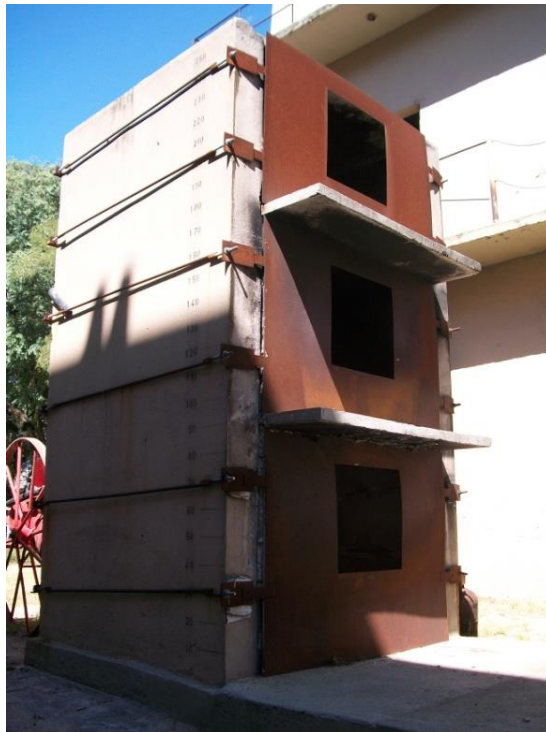
Figura 2. Simulador de incêndio de baixo risco.
