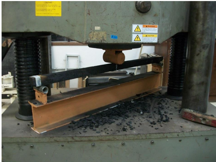
Figura 4. Equipamento de ensaio de resistência à flexão.
