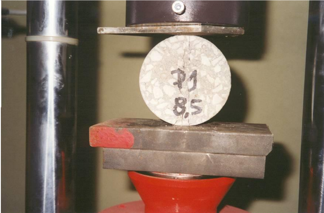
Figura 6. Ensaio de compressão diametral dos discos
