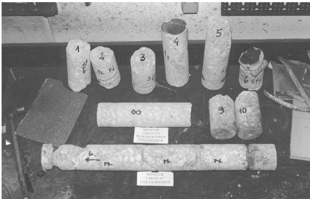
Figura 2. Carotes de betão extraídas das estruturas sujeitas a incêndio
