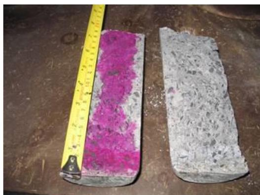
Figura 3. Núcleo ensayado y aplicación del indicado alcalino.
