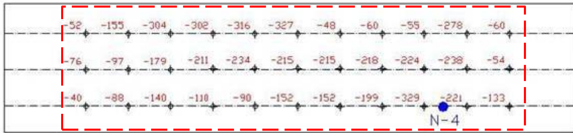
Figura 9. Potenciales de corrosión medidos en la zona reparada de una viga secundaria del primer nivel, parcialmente reparada, en la zona demarcada.
