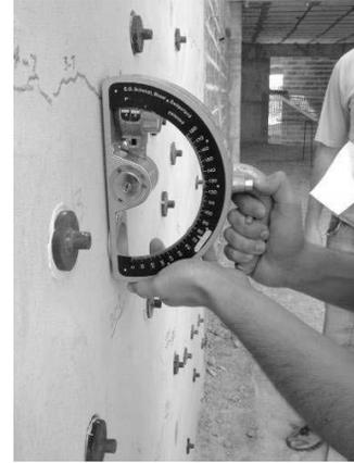
Figura 8. Esclerômetro de pêndulo.
