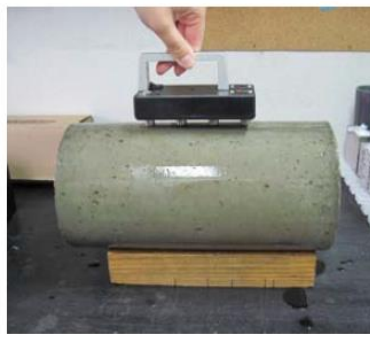
Figura 3. Método de las 4 puntas
