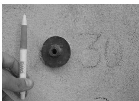
Figura 2. Pastilha metálica colada no revestimento.
