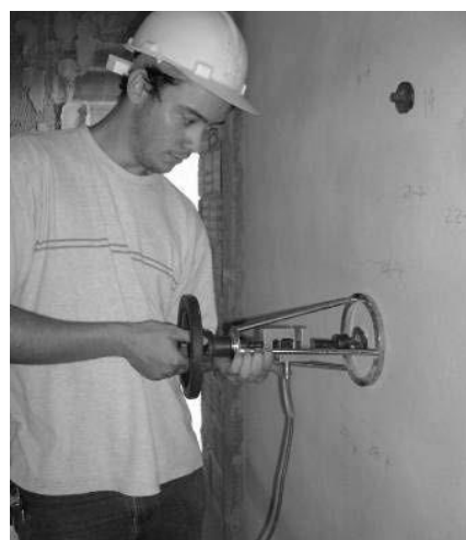
Figura 4. Detalhe da célula de carga do equipamento de arranchamento
