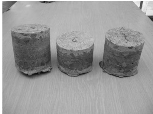
Figura 12. Testigos no fisurados
