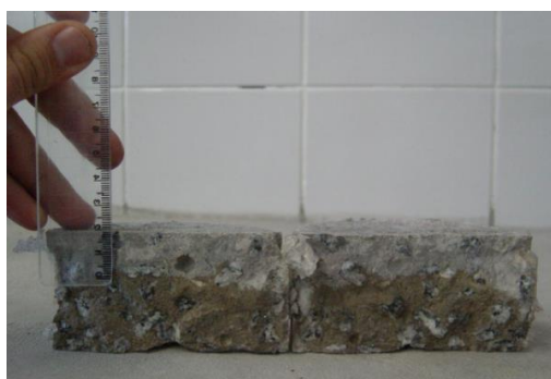
Figura 4. Fatia de corpos de prova após ruptura e aplicação de solução aquosa de 0,1 \text{ M} de \text{AgNO}_3 .
