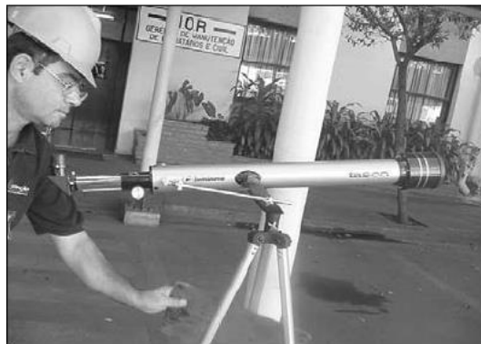
Figura 1. Telescópio para inspeção das superfícies externas.
