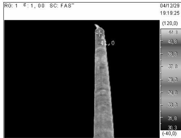
Figura 4. Termograma desta chaminé mostra uma homogeneidade de temperatura.
