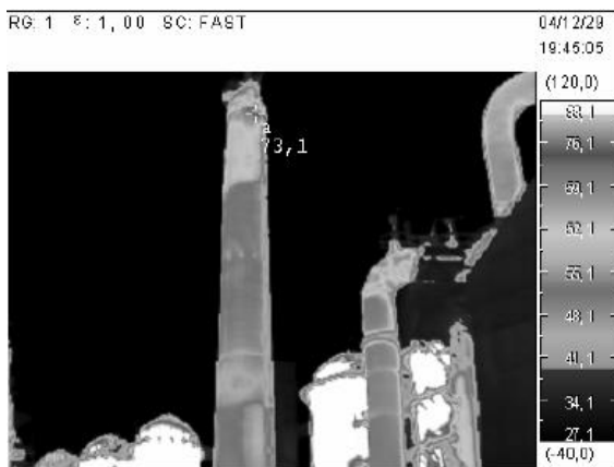
Figura 5. Termograma indica um aumento de temperatura no topo
