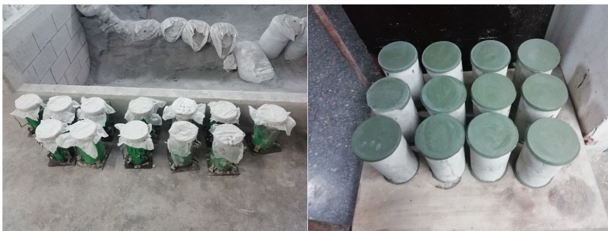
Figura 1. Moldagem e preparação de corpos de prova cilíndricos com 150 mm de diâmetro x 300 mm de altura.
