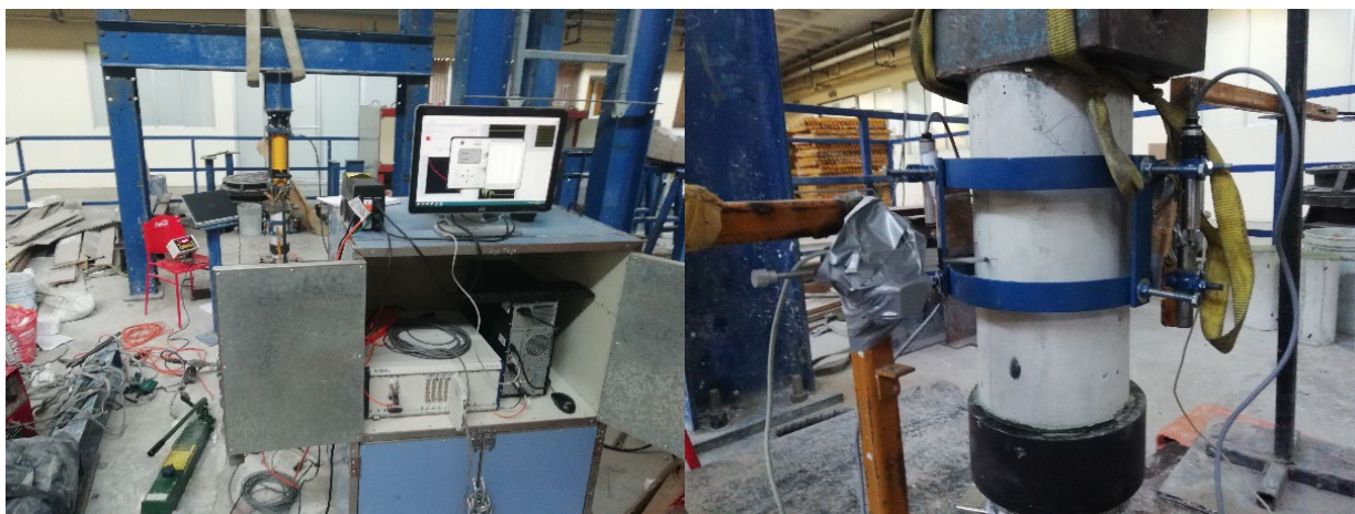
Figura 3. Configuração da instrumentação para ensaios de fluência de curto prazo por compressão mantida
