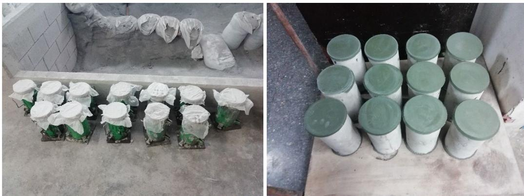
Figura 1. Fabricación y cabeceo de cilindros 150 mm de diámetro x 300 mm de altura.
