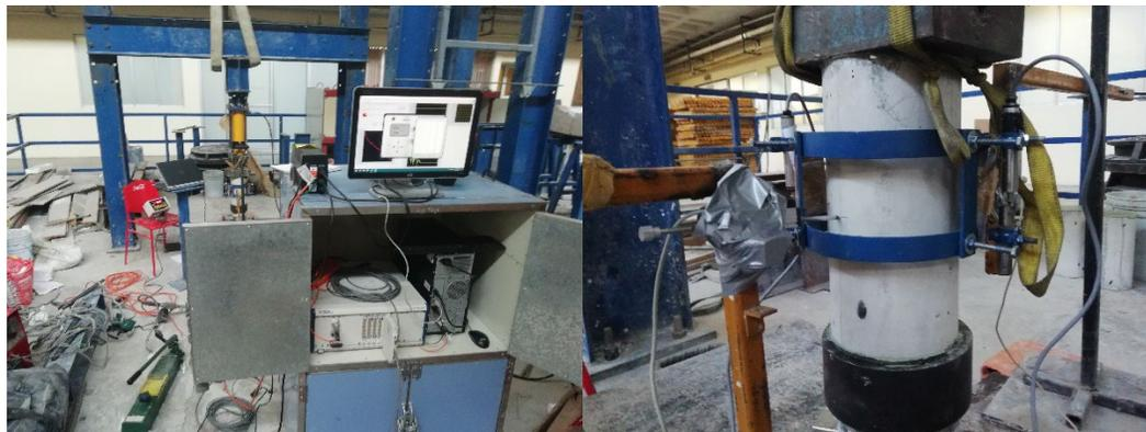
Figura 2. Configuración de la instrumentación para los ensayos de flujo plástico a corto plazo por compresión sostenida.
