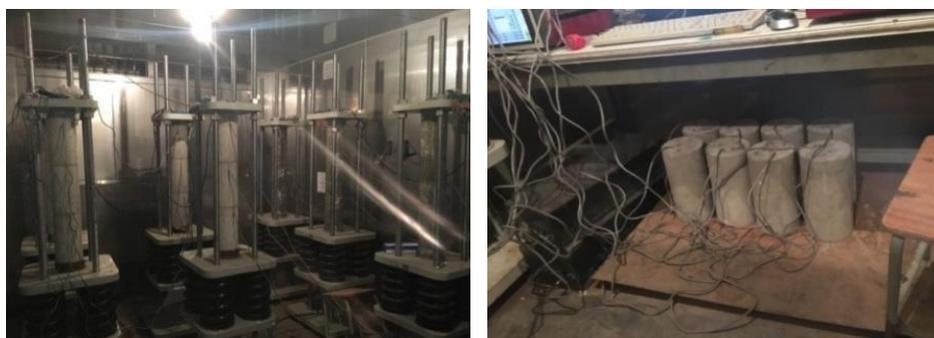
Figura 8. Pruebas de fluencia y contracción en tiempo real en un entorno totalmente controlado. Seúl, Corea.
