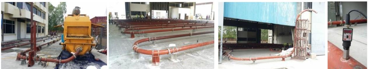
Figura 7. C105 Diseño de tubería horizontal de hormigón para prueba de bombeo.
