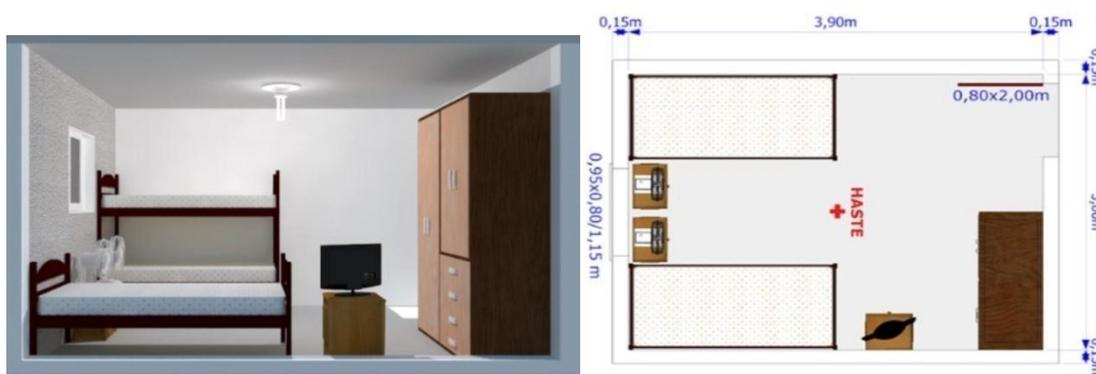
Figura 1. Ilustrações do ambiente ensaiado e distribuição dos termopares.
