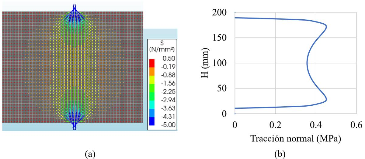
Figura 6. Distribución de los esfuerzos en el bloque antes del agrietamiento. (a) Esfuerzos principales; (b) Tracciones normales en los elementos de interfaz.
