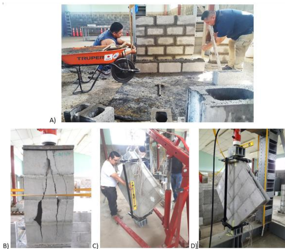
Figura 1. Processo de construção e ensaios em prismas e paredes pequenas(muretas).
