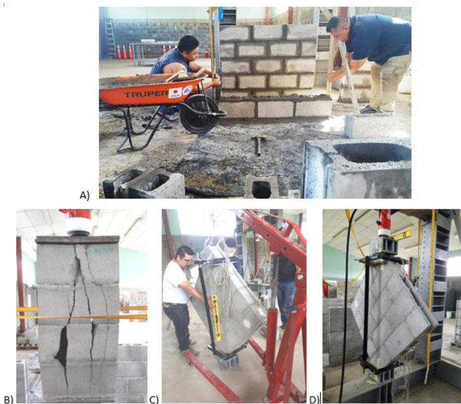
Figura 1. Proceso de construcción, y ensayo de prismas y muretes.
