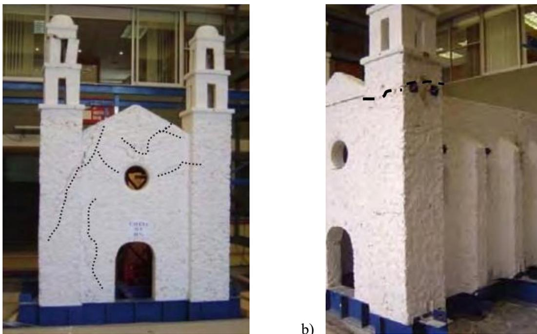
Fig. 6. Principales daños en el modelo a escala sometido a acciones sísmicas, a) tendencia de deterioro y agrietamiento en diagonal en torre izquierda, b) tendencia de falla horizontal en el bloque superior de la torre campanario derecha. Retomada de Chávez M., (2010).
