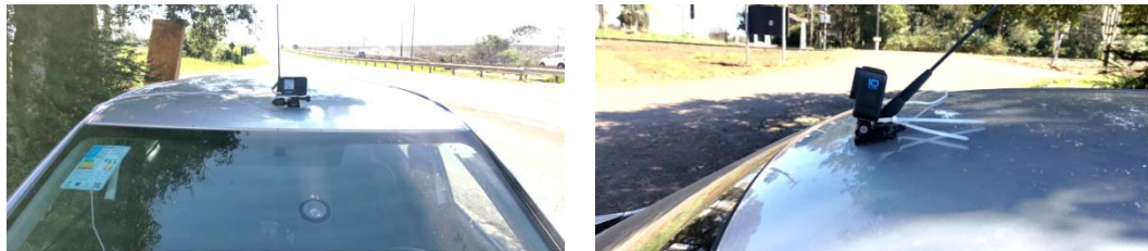
Figura 3. Posicionamento da câmera no veículo
