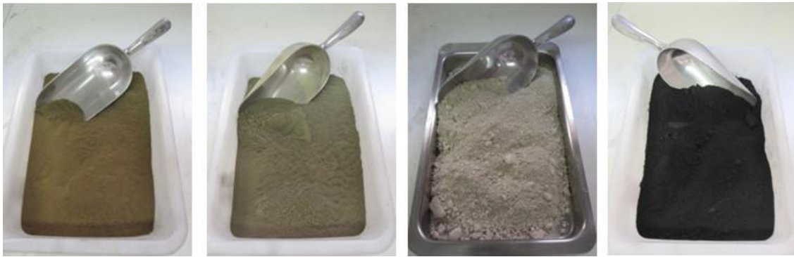
Figura 1. Adiciones minerales utilizadas en la investigación (de izquierda a derecha): Ceniza de lodo de depuradora (CLD); ceniza volante (CV); polvo de mármol (PM); ceniza de cáscara de arroz (CCA).
