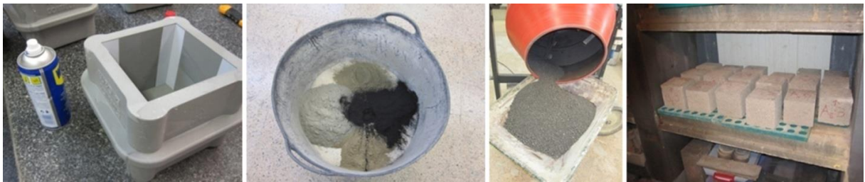
Figura 2. Procedimiento para la fabricación de las probetas de hormigón (de izquierda a derecha): Probetas cúbicas de 150 mm de lado; mezclado previo de los componentes en seco; mezclado en hormigonera; conservación de las probetas en cámara húmeda.
