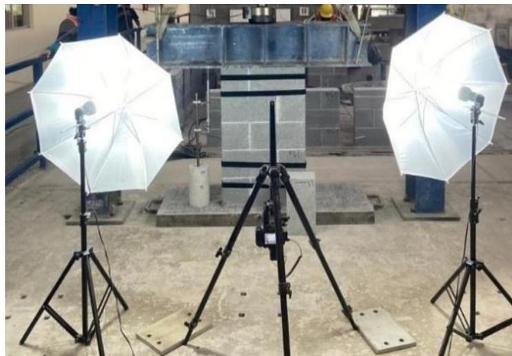
Figura 4. Ensayo en el laboratorio e implementación de la técnica para la captura de imágenes.
