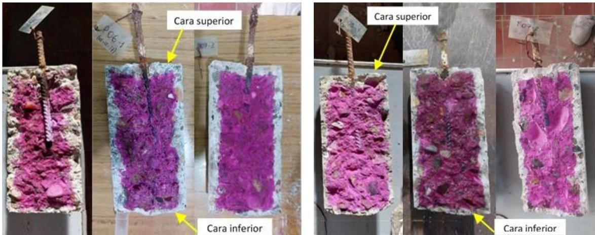
Figura 7. Avanço frontal de carbonato. Esquerda.) Amostras "P-0x". Direito.) Amostras "F-0x".
