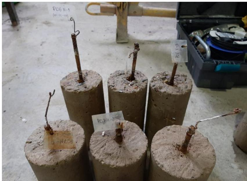
Figura 3. Barra embutida na face superior dos espécimes.
