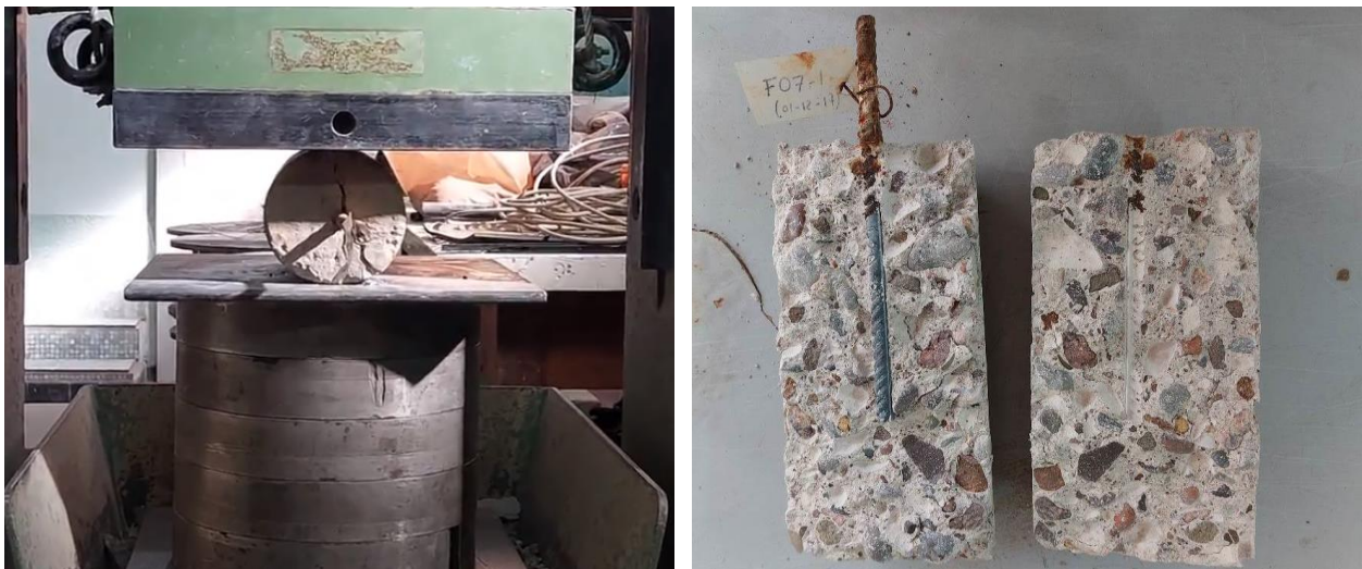
Figura 4. Izq.) Ensayo de tracción por compresión diametral. Der.) Mitades obtenidas del ensayo.
