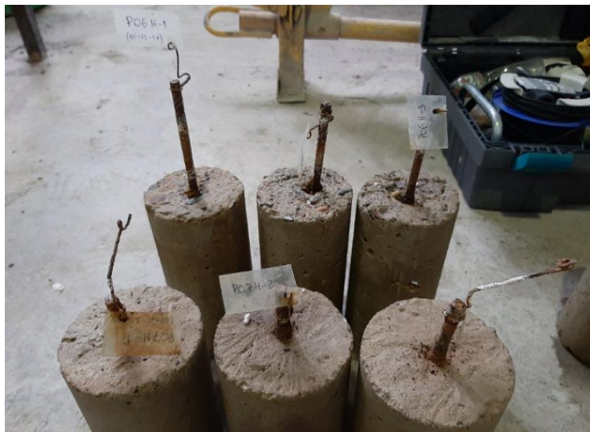
Figura 3. Barra embebida en la cara superior de las probetas.
