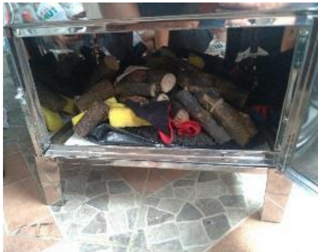
Figuras 4 y 5. Izquierda: Materiales para quema en el interior del recinto. Derecha: Cuerpos de prueba dispuestos dentro del recinto, con cada proporción ubicada en un nivel del recinto.
