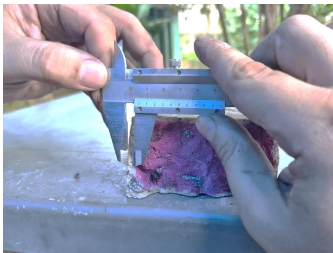
Figura 7. Medición del área carbonatada.
