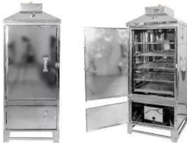
Figura 2. Ahumador utilizado como recinto para la quema de los cuerpos de prueba.
