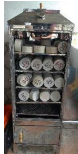
Figuras 4 y 5. Izquierda: Materiales para quema en el interior del recinto. Derecha: Cuerpos de prueba dispuestos dentro del recinto, con cada proporción ubicada en un nivel del recinto.
