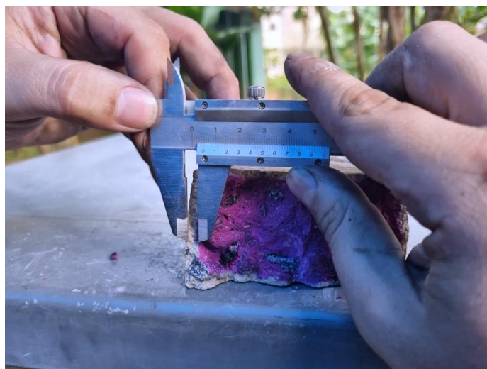
Figura 7. Aferição da área carbonatada
