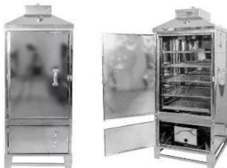
Figura 2. Defumador utilizado como invólucro para queima dos corpos de prova.
