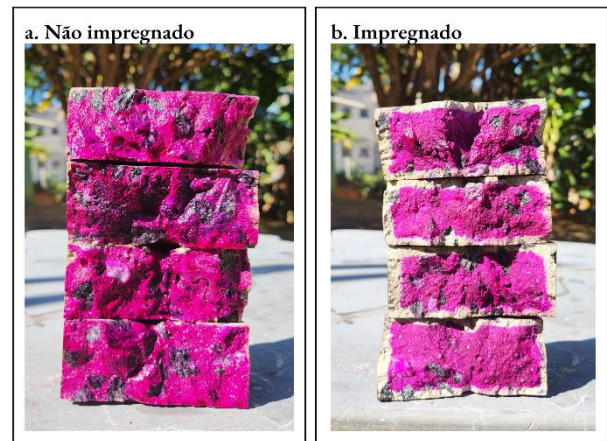
Figura 8. Comparação da aferição da frente de carbonatação com fenolftaleína, no traço de relação água/cimento 0,55, ao final dos 360 dias de experimento
