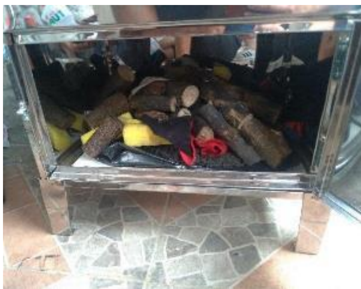
Figuras 4 e 5. Esquerda: Materiais para queima no interior do invólucro. Direita: Corpos de prova dispostos no interior do invólucro, sendo que cada traço foi disposto em um nível do invólucro.
