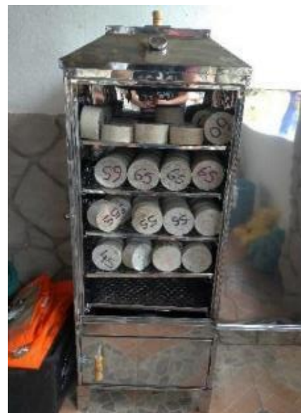
Figuras 4 e 5. Esquerda: Materiais para queima no interior do invólucro. Direita: Corpos de prova dispostos no interior do invólucro, sendo que cada traço foi disposto em um nível do invólucro.
