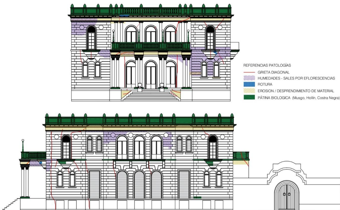
Figura 4. Análise de patologia nas faces Leste e Oeste do edifício.
