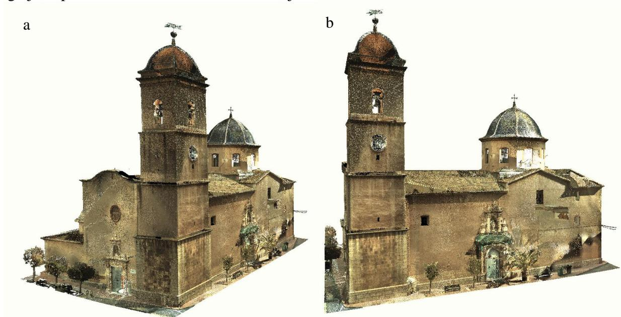
Figura 1. Fachadas principais da igreja obtidas mediante levantamento topográfico com Laser-Scanner. (a) Acesso Principal, (b) Fachada de San Pedro.
