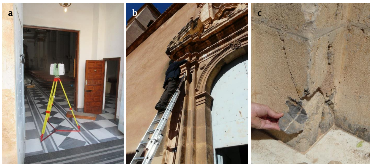
Figura 4. Diferentes aspectos de la toma de datos y muestras. a) Detalle del registro geométrico con escáner láser. b) Recogida de muestras de fragmentos sueltos sobre la cornisa. c) Lasca de piedra negra en esquina inferior para su observación.
