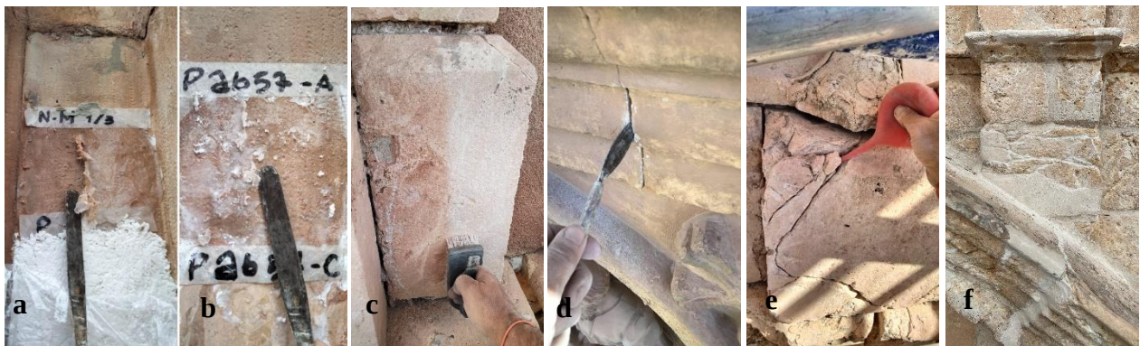
Figura 11. Diferentes aspectos de ensayos previos de limpieza y sellado de grietas.
