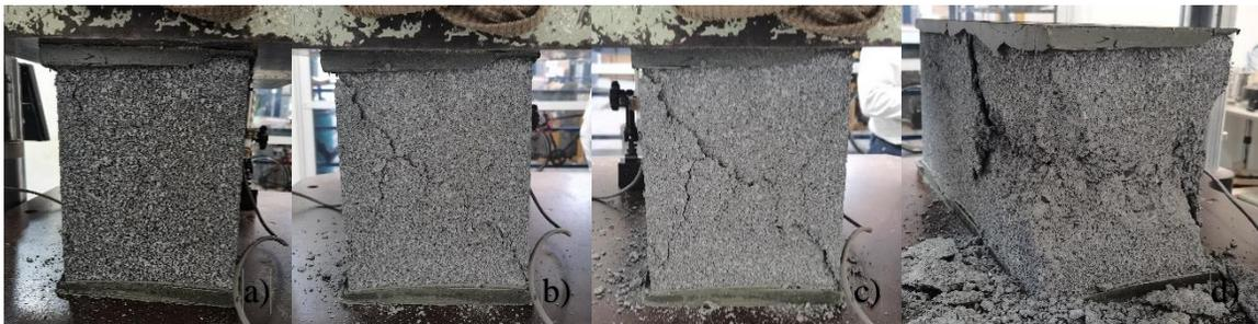
Figura 6. Etapas do processo de craqueamento no BHC com o uso de pitching na área bruta: a) A fissuração começa nos cantos do bloco, b e c) desenvolvimento de rachaduras em direção ao centro das faces do bloco, d) desprendimento de segmentos do material. Fonte: elaboração própria.
