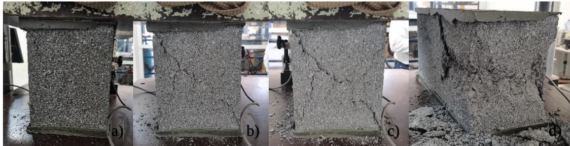
Figura 6. Etapas del proceso de agrietamiento en los BHC con el empleo del cabeceo sobre el área bruta: a) Comienza el agrietamiento en las esquinas del bloque, b y c) desarrollo de las grietas hacia el centro de las caras del bloque, d) desprendimiento de segmentos del material.
