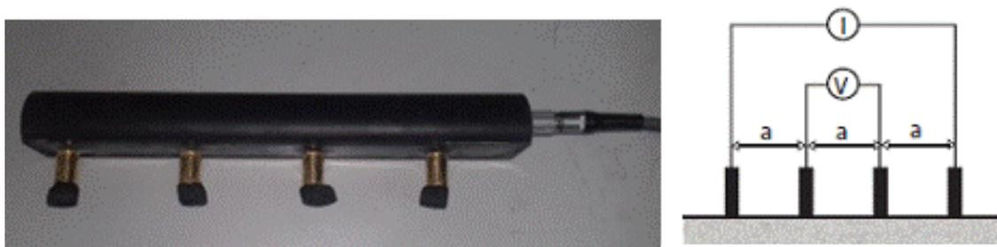
Figura 2. Sonda Wenner utilizada. Esquema de medição.
