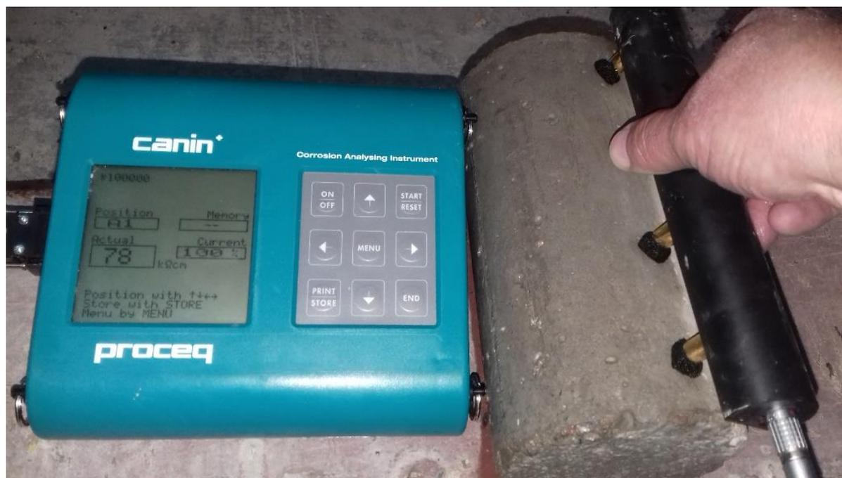
Figura 3: Procedimento de medição de resistividade. Dispositivo CANIN. Sonda Wenner.
