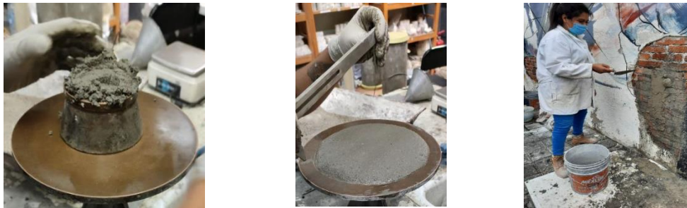
Figura 3. Ensaio em misturas de argamassa: (a) Moldagem; (b) Consistência; (c) Aderência. Fonte: (Durán, 2021).
