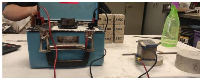
Figura 4. Equipamento de resistividade elétrica Nillson 400.
