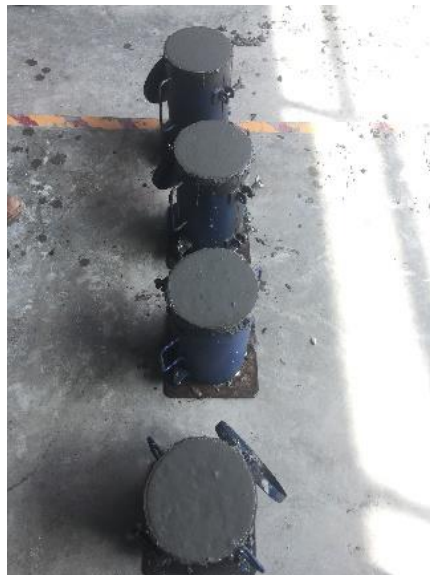
Figura 2. Preparação de cilindros para testes
