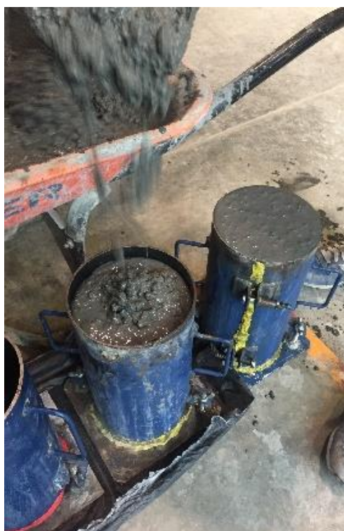
Figura 1. Preenchimento dos cilindros com concreto autoadensável.
