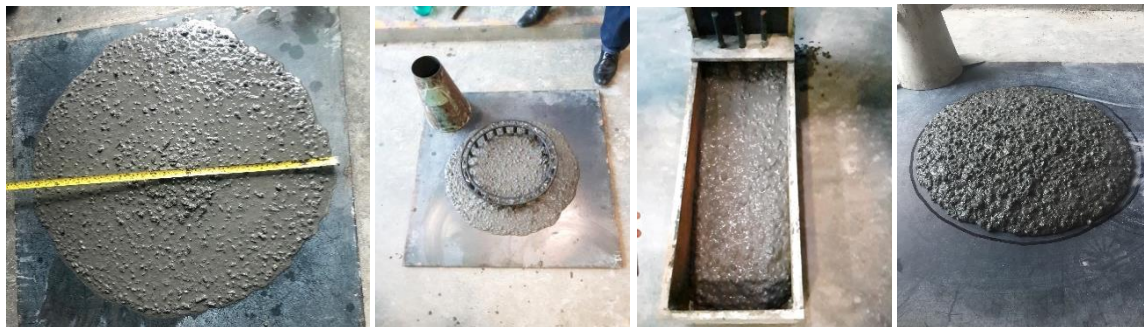
Figura 3. Caracterização do traço no estado fresco para avaliação dos parâmetros elementares de trabalhabilidade de um CAA.
