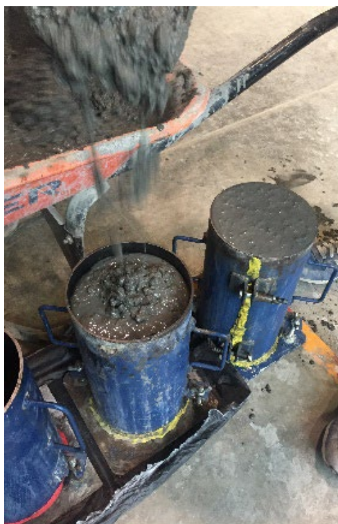
Figura 1. Llenado de cilindros con concreto autocompactable.
