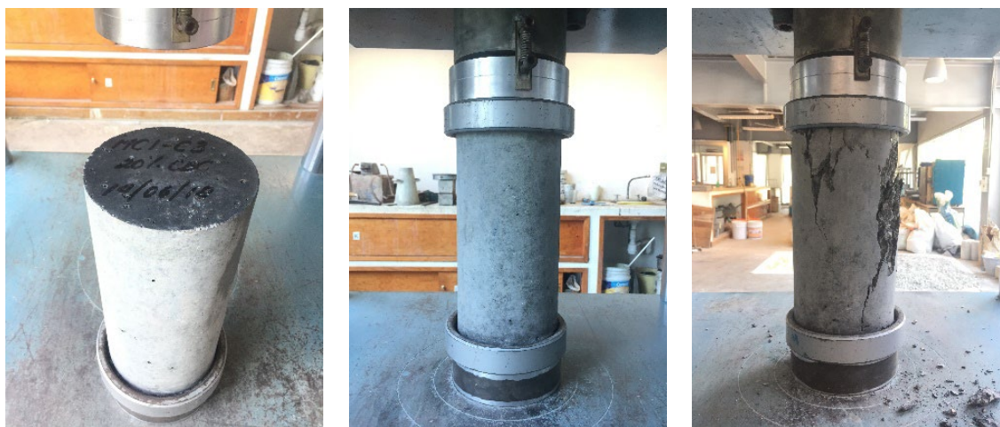
Figura 4. Secuencia de los ensayos de resistencia a compresión.
