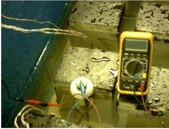
Figura 4. Monitoreo con multímetro y electrodo de referencia Cu/CuSO<sub>4</sub>
