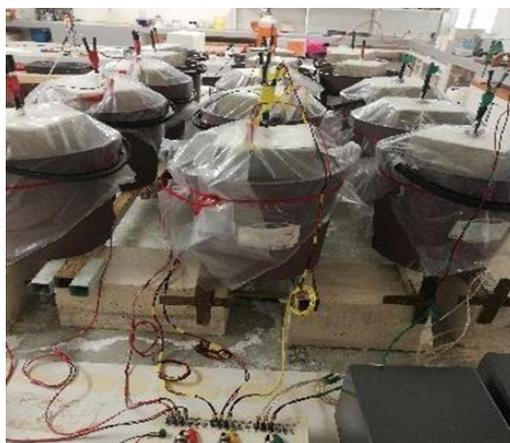
Figura 2. Montaje experimental usado para la realcalinización electroquímica.
