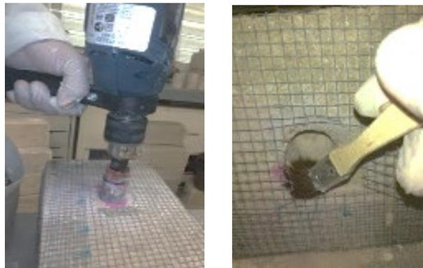
Figura 3. Extracción de cilindros y muestras de polvo.
