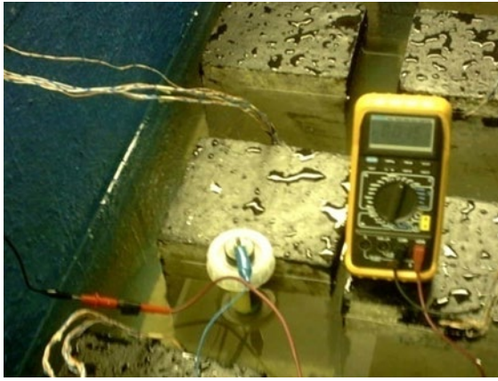
Figura 4. Monitoreo con multímetro y electrodo de referencia Cu/CuSO 4
