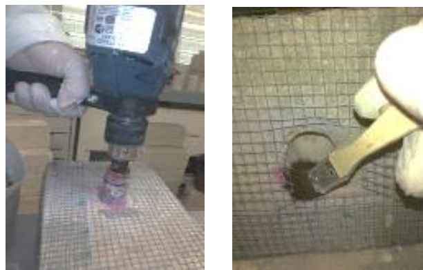
Figura 3. Extracción de cilindros y muestras de polvo.
