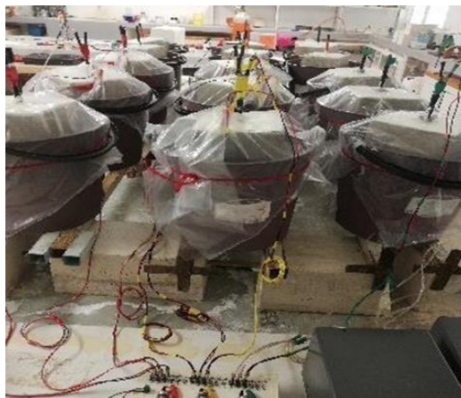
Figura 2. Montaje experimental usado para la realcalinización electroquímica.
