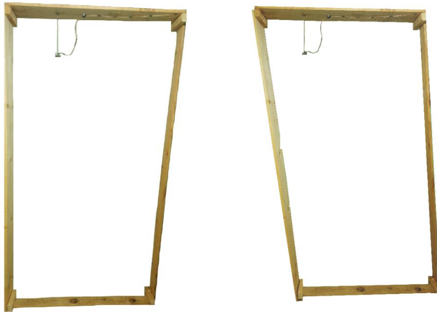
Figura 5. Instrumentação do modelo com sensores HC-SR04.
