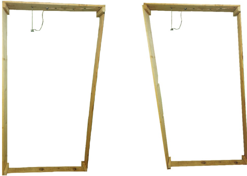
Figura 5. Instrumentación del modelo con sensores HC-SR04 .
