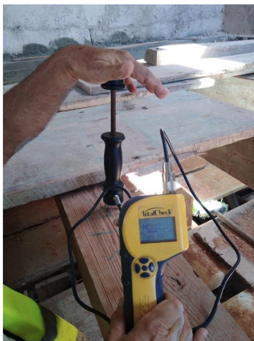
Figura 11. Medição da umidade da superfície com o equipamento termo-higrômetro TotalCheck da Delmhorst
