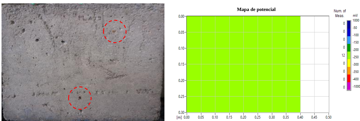
Figura 9. (a) “Absorção” dos produtos de corrosão através dos poros; (b) Mapa relativo ao potencial de corrosão (efeitos graves não aparentes).
