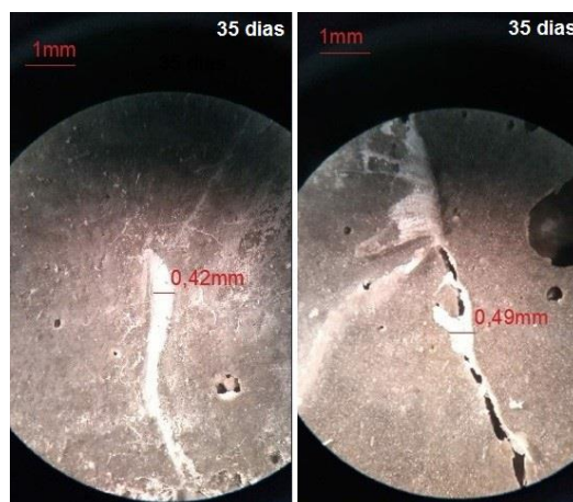
Figura 7. Autocuración en la mezcla BAC.AE - Muestras 3 y 1.
