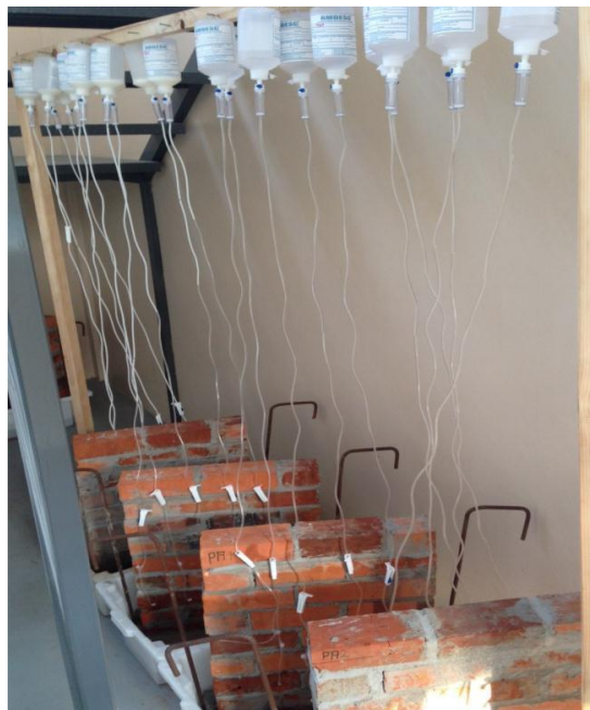
Figura 4. Aplicación de bloqueadores químicos.
