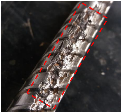
Figura 19. Pérdida de masa de barras de acero (L3).
