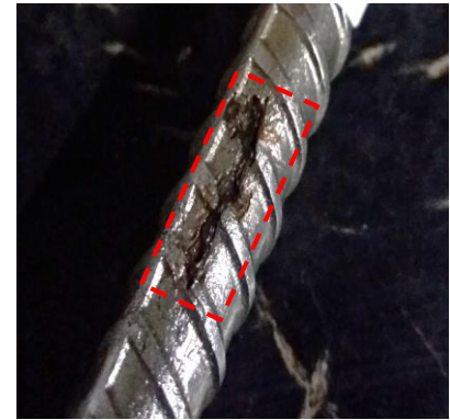
Figura 21. Pérdida de masa de barras de acero (L1).
