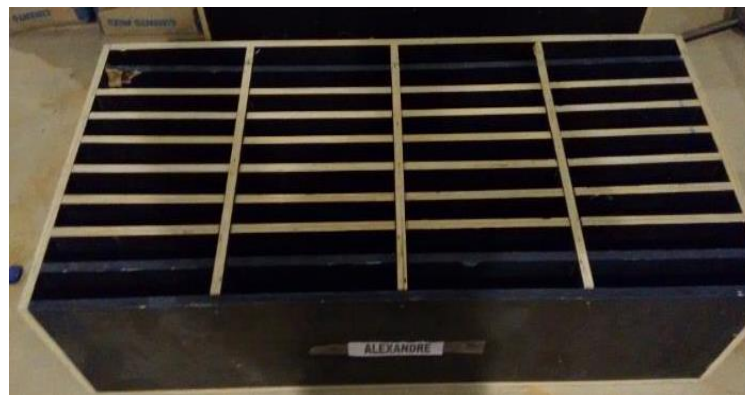
Figura 4. Molde rectangular capaz de producir 36 moldes.
