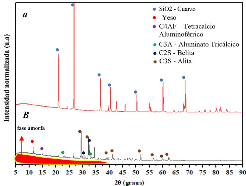
Figura 6. Difracción de rayos X de agregado fino natural (a) cemento Portland/aglomerante (b).
