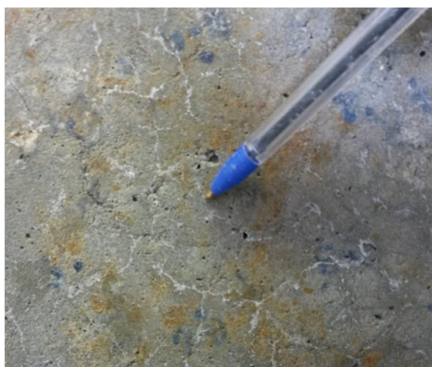
Figura 13. Microfisuras en los cuerpos de prueba.
