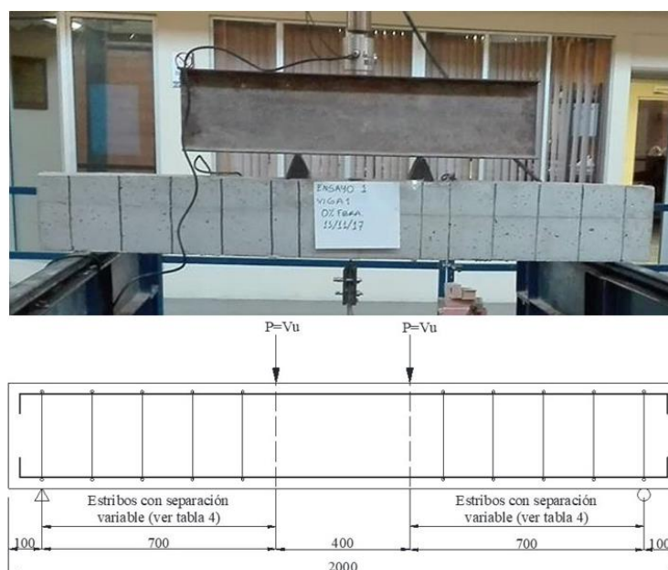
Figura 1. Arreglo general del ensayo de las vigas
