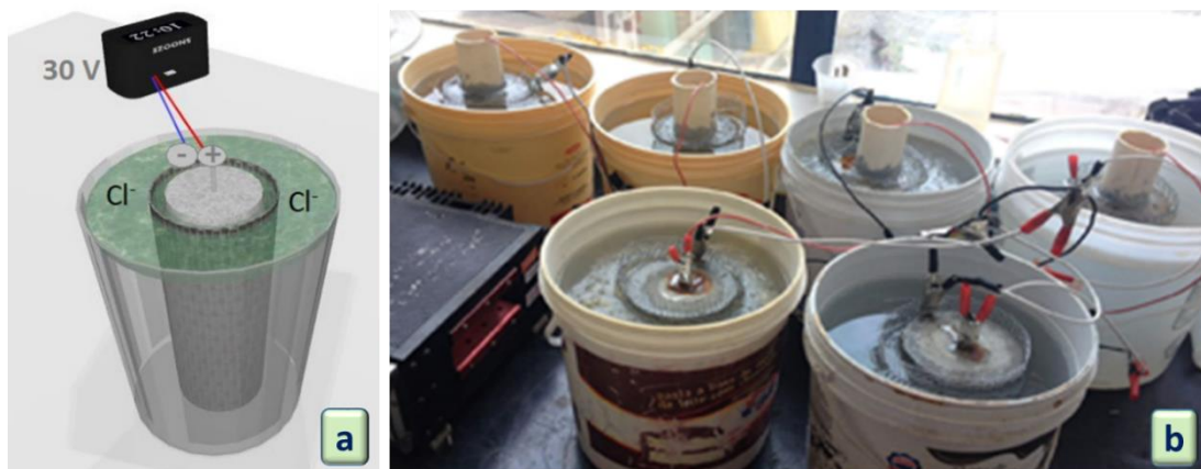
Figura 3. Esquema de ensaio de migração de cloretos: (a) esquema da ligação elétrica; (b) foto do experimento montado.
