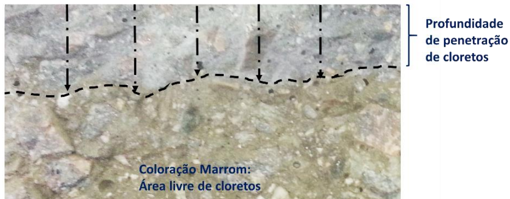
Figura 7. Ilustração do contraste obtido com a aplicação do método colorimétrico para a determinação da profundidade de penetração de cloretos, usando aspersão de uma solução de NaOH e uma de \text{AgNO}_3 .
