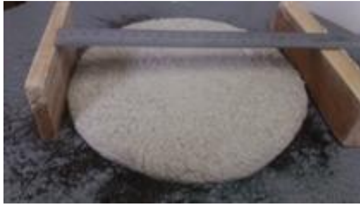
Figura 3. Verificação do espalhamento para determinação da consistência dos compósitos cimentícios.
