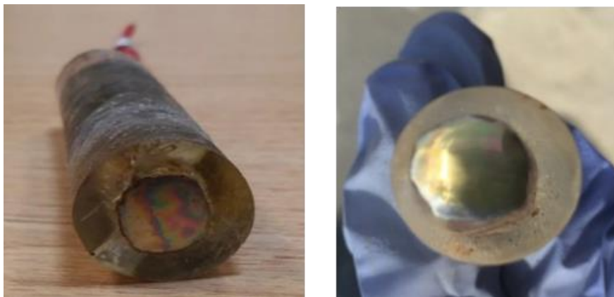
Figura 1. Tonalidade que se observa na superfície da amostra com revestimento.
