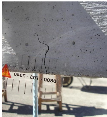
Figura 3. Medida da abertura de fissura no centro do corpo-de-prova prismático com fissurômetro.
