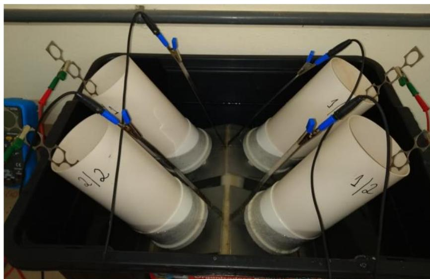
Figure 4. Chloride diffusion test apparatus.
