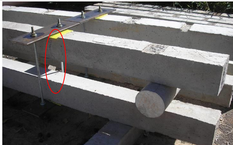
Figura 8. Mapeo de fisuras en modelos de hormigón que ha estado bajo carga central permanente durante 24 meses (M24umCCP).
