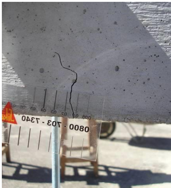
Figura 3. Medición de la apertura de la fisura en el centro de la muestra prismática con un fisurómetro.
