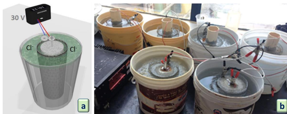
Figura 3. Esquema del ensayo de migración de cloruros: (a) esquema de la conexión eléctrica; (b) foto del experimento montado.
