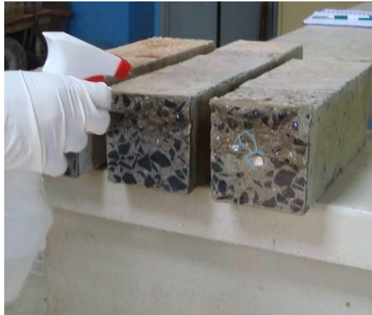
Figura 5. Ensayos de penetración de cloruro con spray de nitrato de plata.
