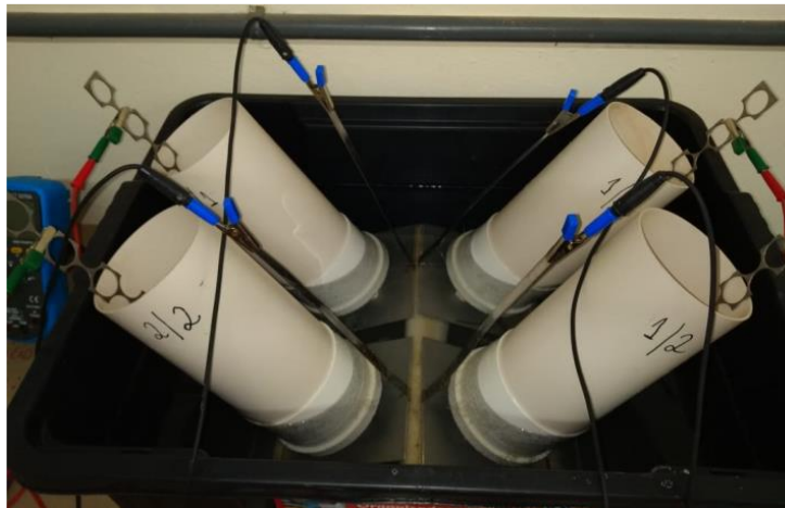
Figura 4. Aparato para realización del ensayo de difusión de cloruros.
