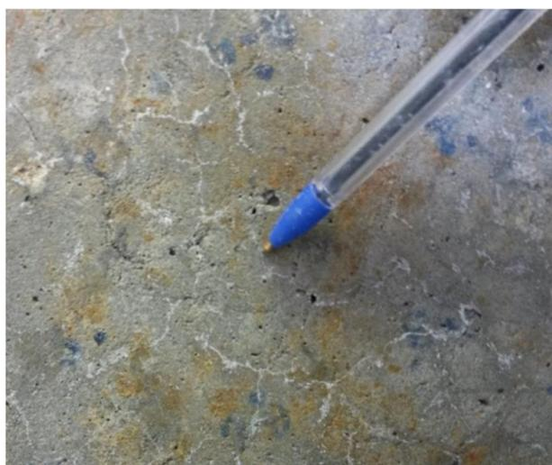
Figura 13. Microfisuras en los cuerpos de prueba.
