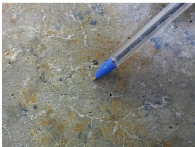
Figura 13. Microfissuras nos corpos de prova.
