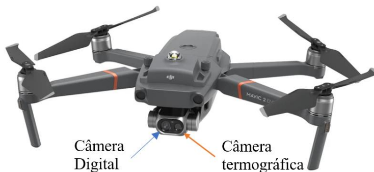
Figura 3. VANT com câmera termográfica acoplada à câmera digital. (Topdrone, 2020).
