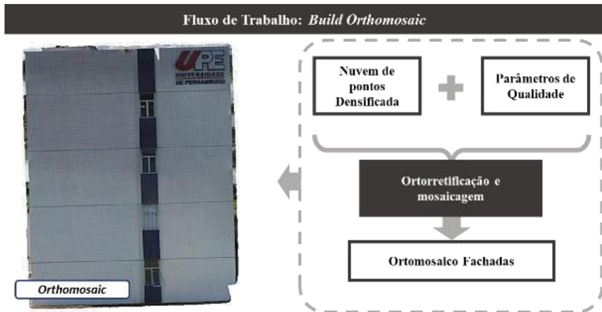
Figura 10. Modelo Ortomosaico da Fachada Sul IIT-UPE.
