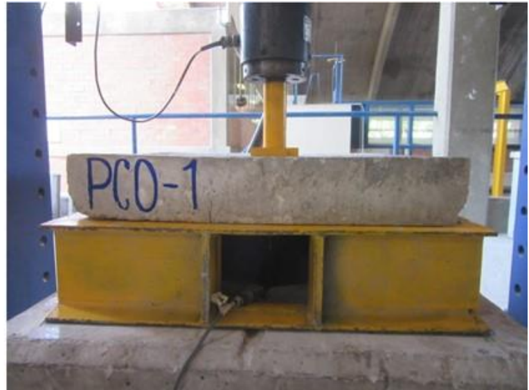
Figura 2. Esquema de configuração do ensaio de painel, segundo a EN 14488-5
