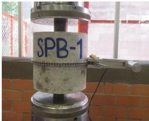
Figura 11. Ensaio de dupla punção, configuração, UNE 83515
