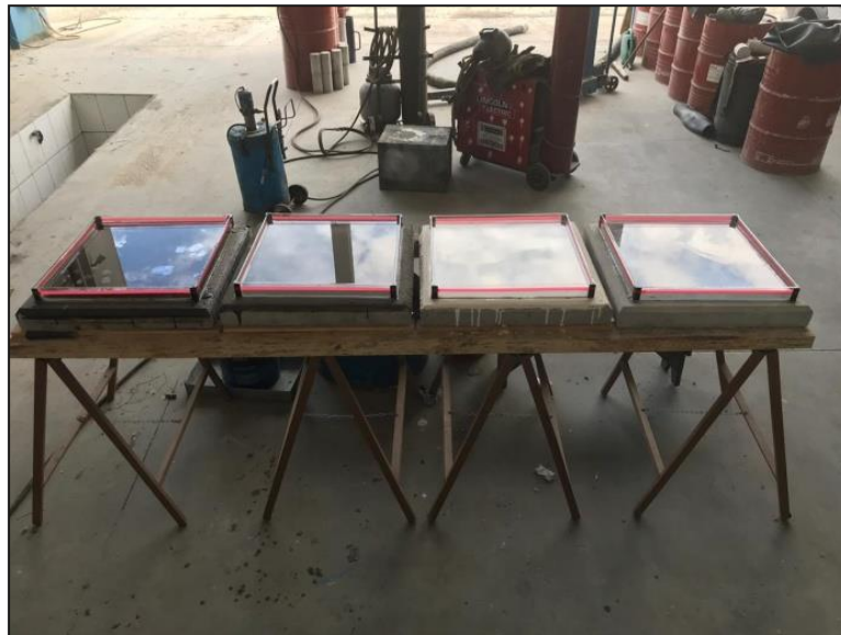
Figura 1. Teste de estanqueidade realizado em laboratório.
