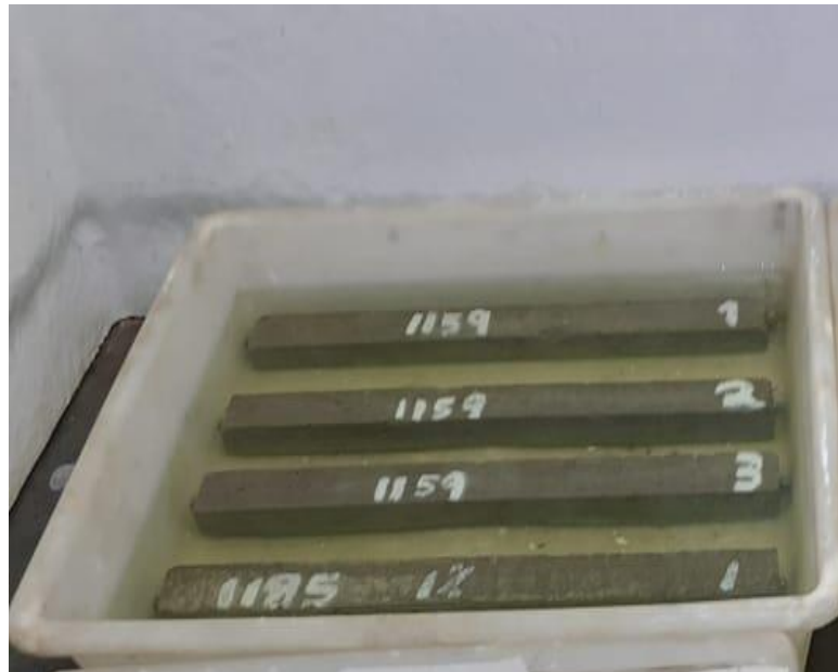
Figura 3. Corpos de prova imersos em solução de NaOH para realização dos ensaios de expansão.
