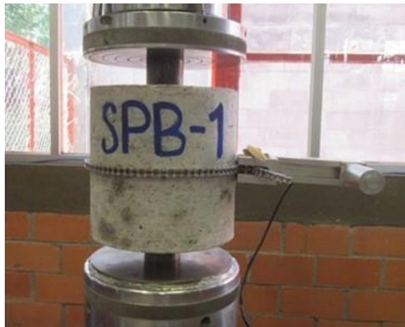
Figura 11. Ensayo de doble punzonamiento, configuración, UNE 83515
