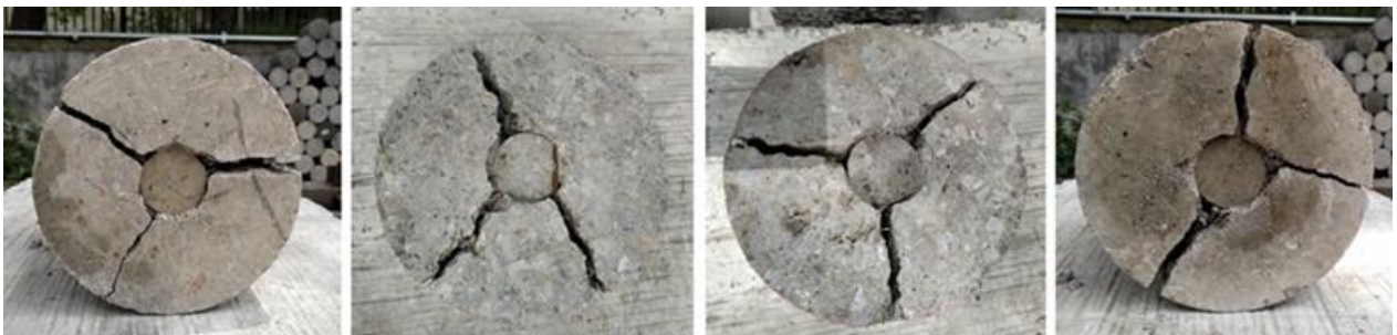
Figura 12. Modo de falla típico de los cilindros, Ensayo Barcelona.
