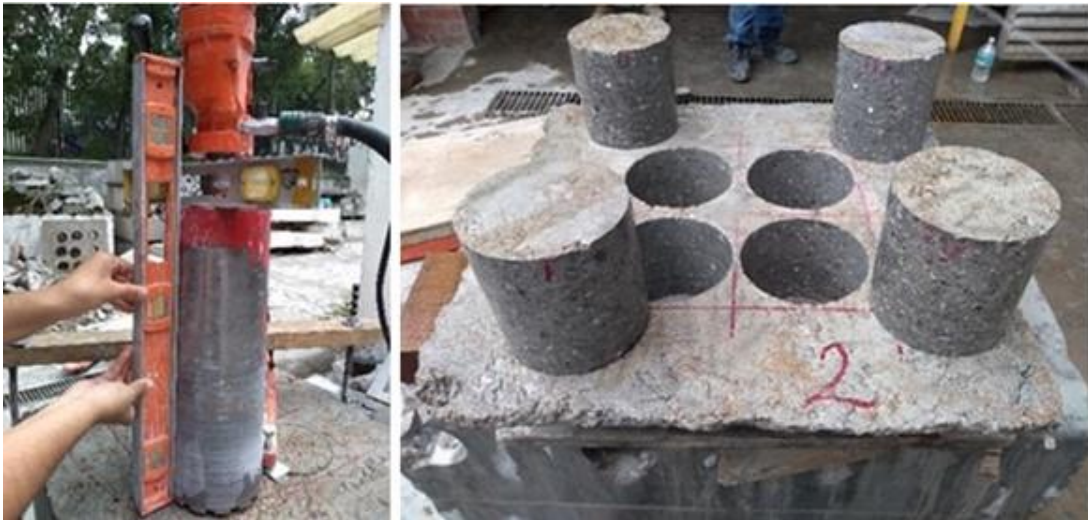
Figura 10. Extracción de testigos para Ensayo Barcelona.
