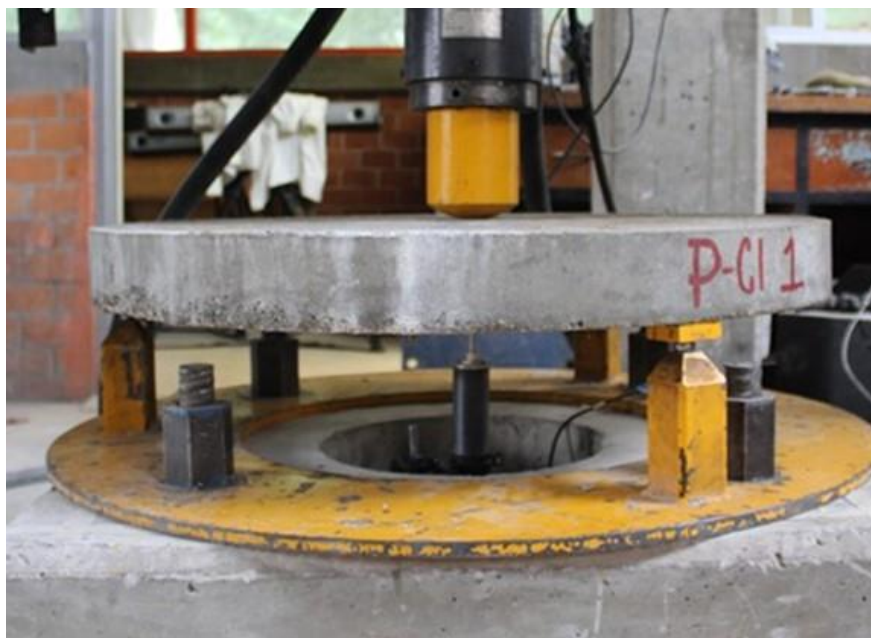
Figura 7. Ensayo de panel de sección circular, ASTM C1550
