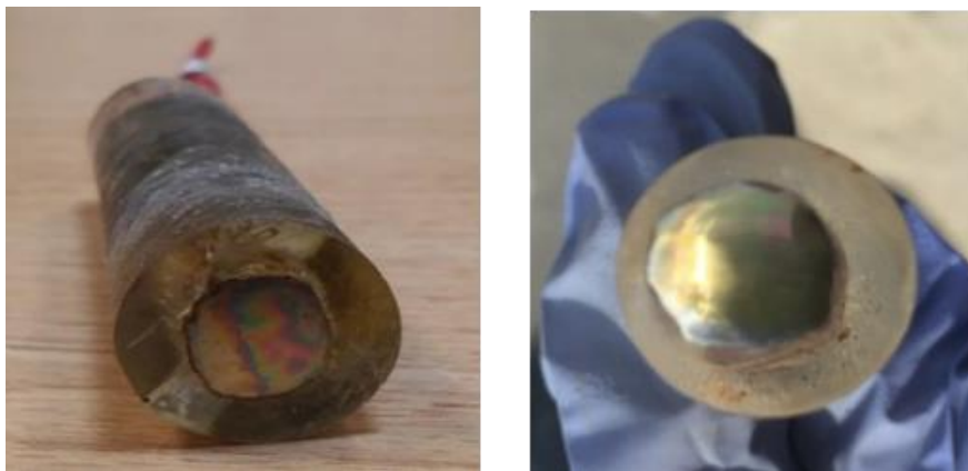
Figura 1. Tonalidade que se observa na superfície da amostra com revestimento.
